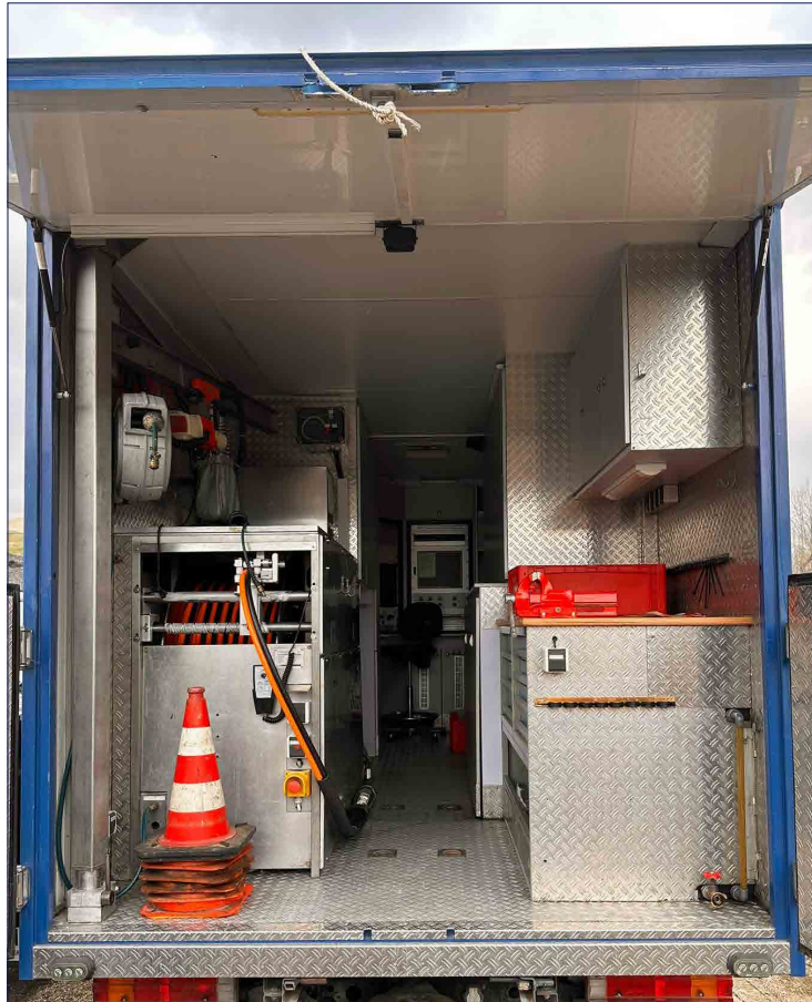
Kabeltrommel des umgebauten KASRO Fräsfahrzeugs
